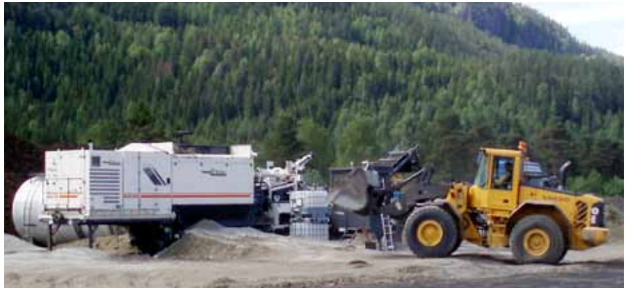
Produksjon av kald gjenbruksasfalt med bruk av skummingsteknikk.
