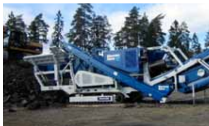
Knusing av asfaltflak i Feiring Bruk.
