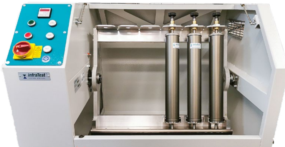
FIGUR 1: Veiteknisk Institutts nye «våndskak» med tre sylindre montert.
