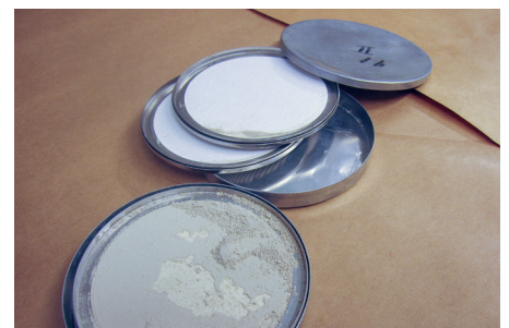
Analyse av filter fra støvmåling på asfaltfabrikk.
