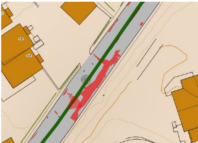
Bearbeidet skadebilde av samme vei.
