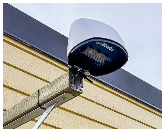
Svevestøvmåleren, et lett, laserbasert partikkel-instrument som kan måle støvfraksjoner mellom PM2.5 og PM10, samt temperatur og relativ fuktighet.
