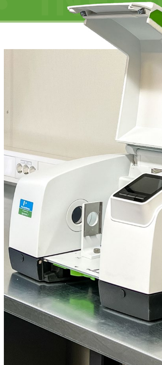
Bindemiddeltipe kan fastslås ved FTIR (Fourier transform infrarød spektroskopi-analyse).
