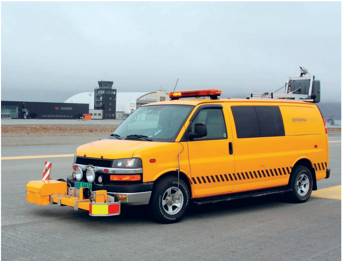
Veiteknisk Institutt utførte måling av makrotekstur på rullebanedekket på Svalbard Lufthavn i 2011.
