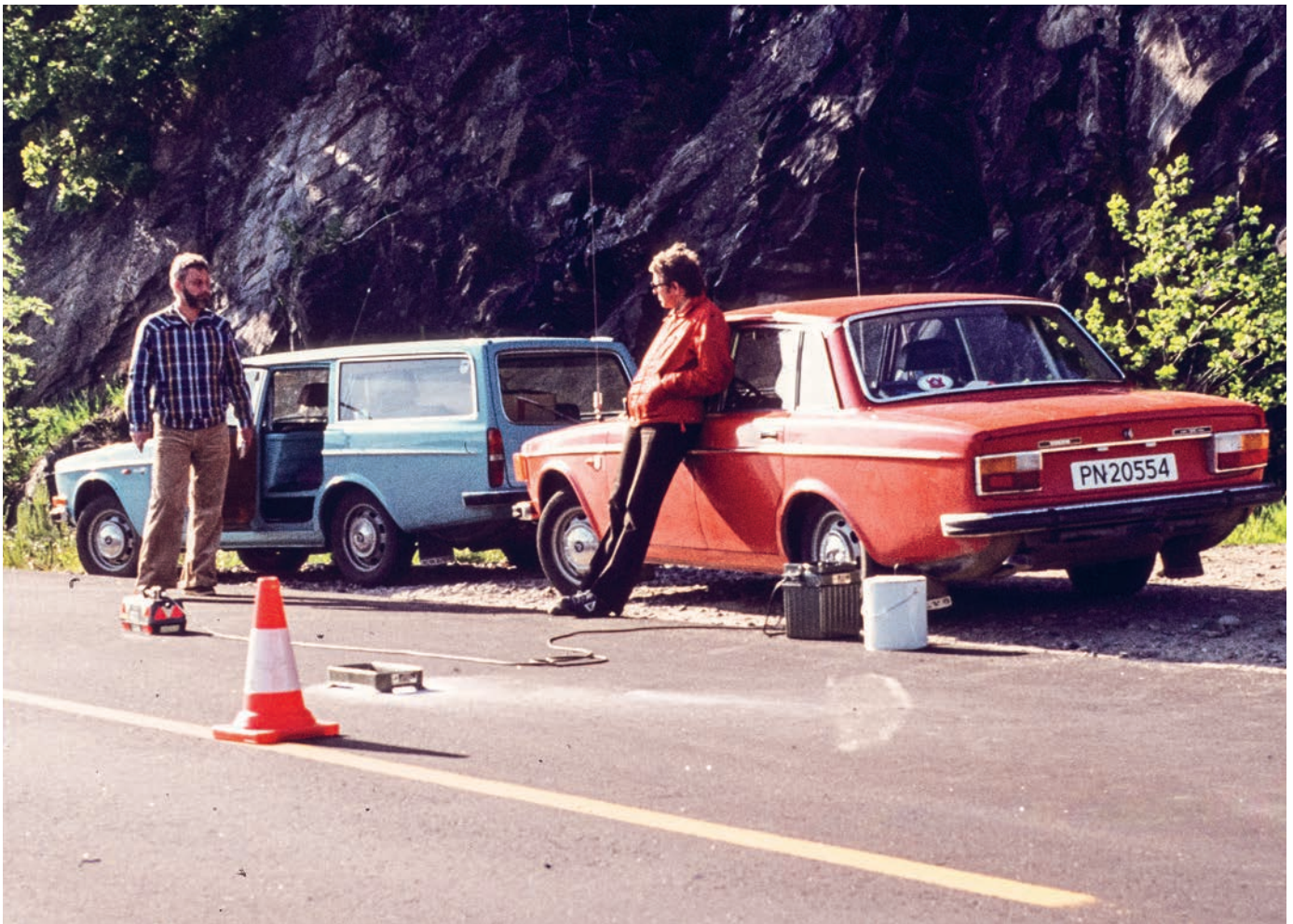
Per Dahl fra Nodest, og Ragnar Evensen fra AIL, kontrollerer hulrom i asfaltdekke med densitetsmåler (1976).
