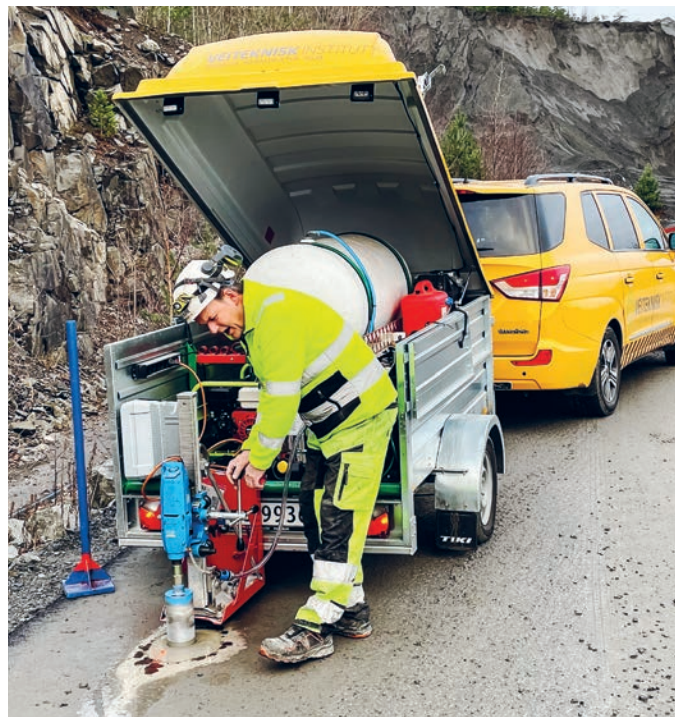
Borkjerneprøver av asfalt tas for dokumentasjon av tykkelse, hulrom, vedheft, kornkurve og bindemiddelinhold.
