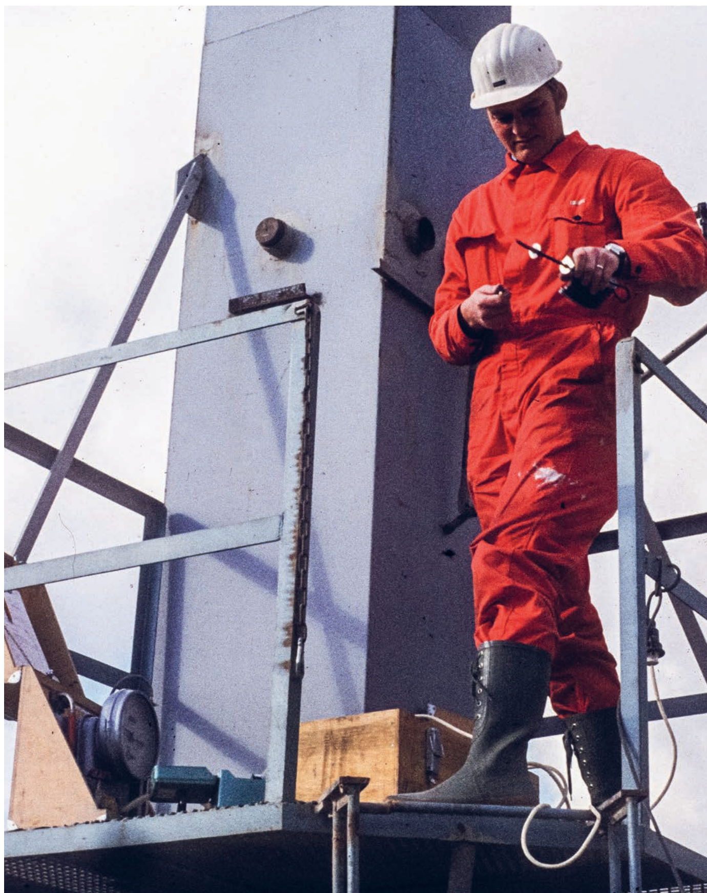
Per Husby fra AIL, utfører støvmåling i skorstein på asfaltfabrikk (1975).
