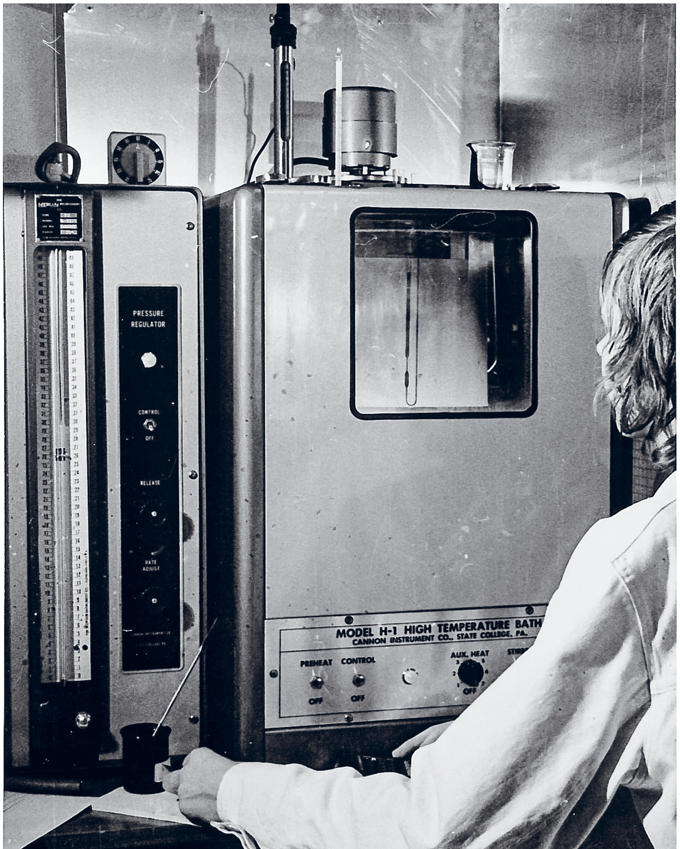
Bilde fra slutten av 1970-tallet, der Roar Telle måler viskositet i bitumen.
