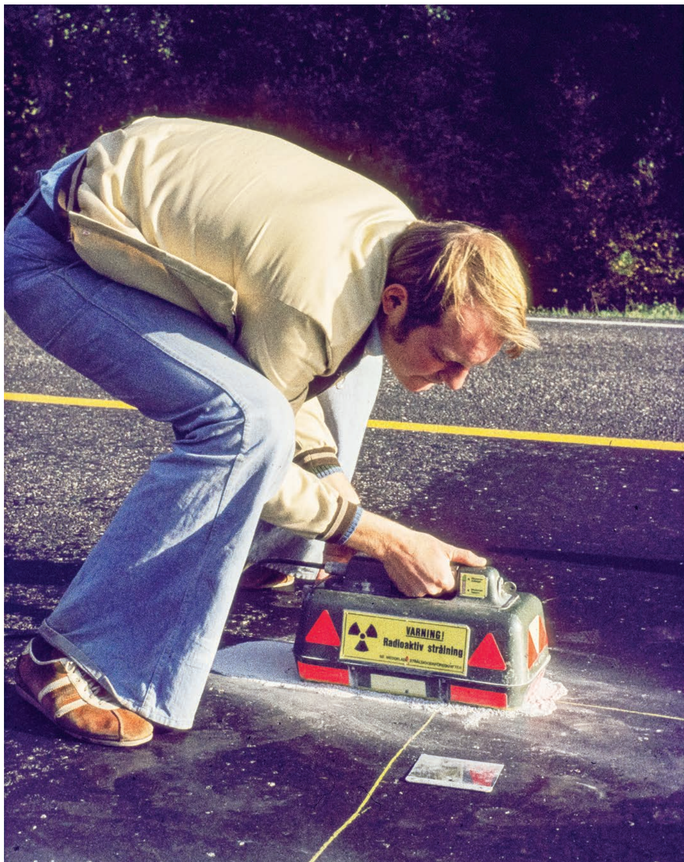
Per Husby fra AIL, utfører utprøving av isotopmåler (densitetsmåler) i 1975.
