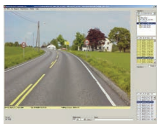
Automatisk fotografering (VidKon) av veibanen.
